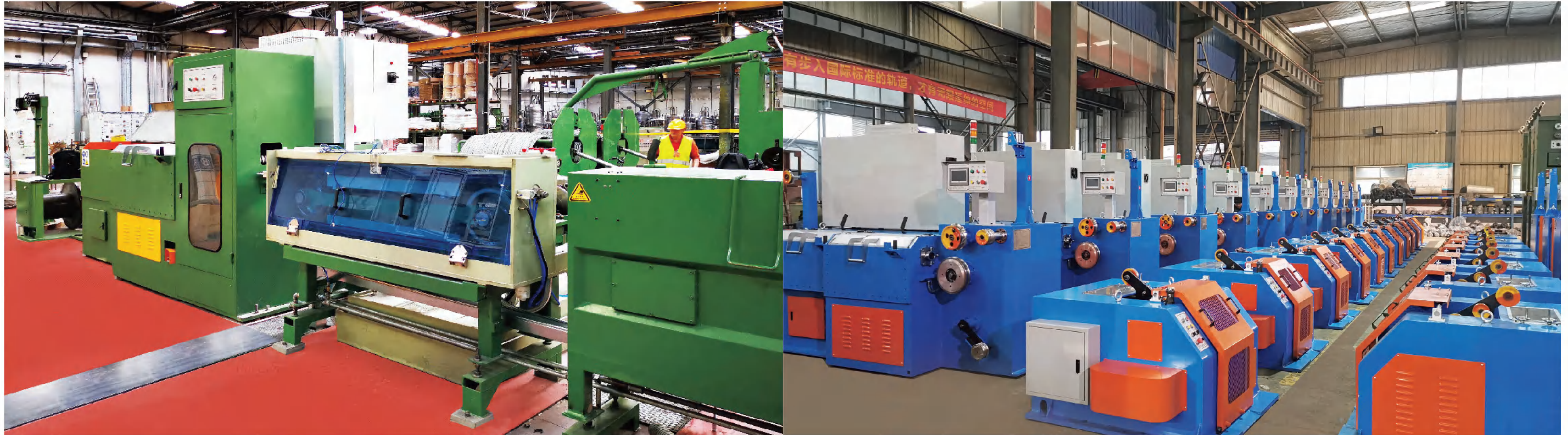
ZT380水箱拉丝机（高碳钢弹簧线）
